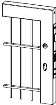
Die Falle kann im eingebauten Zustand mit einer Zange herausgezogen werden und der Öffnungsrichtung entsprechend gedreht werden.
