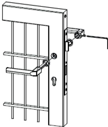
Drückerpaar (inkl. Drückerführungsringen) von aussen nach innen durch den Vierkant des Schlosses schieben und innen mit einem 3er Steckschlüssel festziehen.
