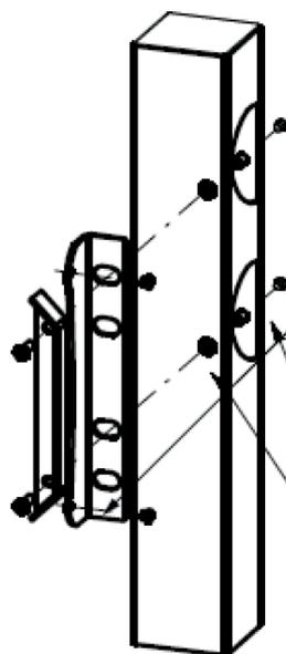
Anschlag entsprechend der Öffnungsrichtung mit Linsenschraube M8x30 und Stiftschlüssel SW 5 wie abgebildet montieren. Gummipuffer in den Anschlagwinkel eindrücken. Feinjustierung zum Schluss der Montage vornehmen. (klappern der Flügel ausgleichen)
