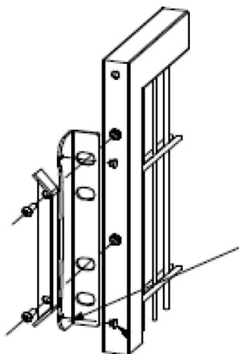
Anschlag entsprechend der Öffnungsrichtung mit Linsenschraube M8x30 und Stiftschlüssel SW 5 wie abgebildet montieren. Gummipuffer in den Anschlagwinkel eindrücken.
