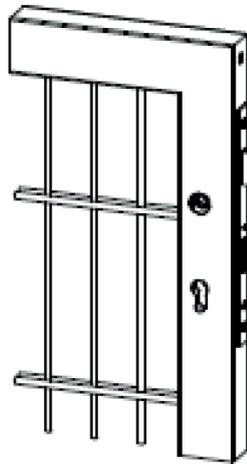
Die Falle kann im eingebauten Zustand mit einer Zange herausgezogen werden und der Öffnungsrichtung entsprechend gedreht werden.
